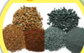
パウダー、5mmアンダー、12mm アンダーに分別して目的別 により製品化
