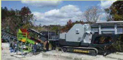
解体工事にもなって発生したコンクリート塊を、再生クラッシャーラン (RC-40) として自社処分場にて生産、販売しております。宮崎リサイクル認定製品 (循環資源100%、利用割合コンクリート塊100%) として、道路舗装の下層路盤材や土木構造物の裏込め材、基礎材などに使用されています。
