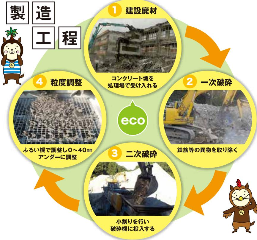
解体工事・土木工事現場などから搬出されたコンクリートやアスファルトコンクリートを破碎し、粒度調整したリサイクル製品です。
