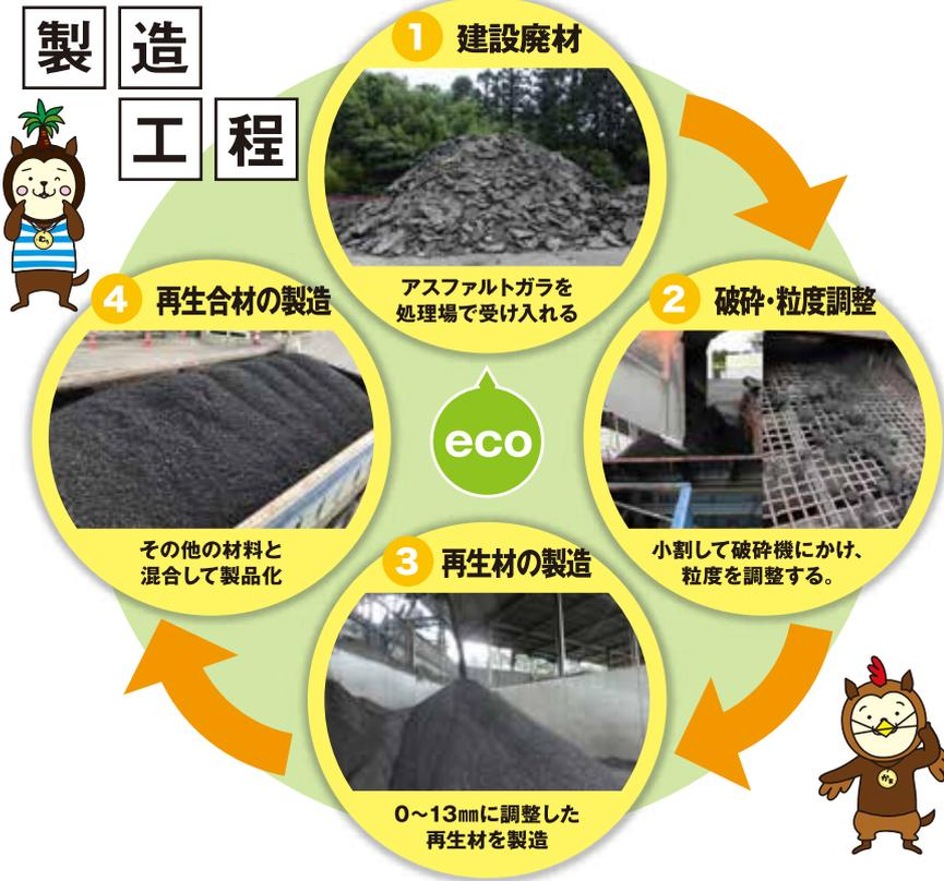
建設現場で発生したアスファルトガラを破碎・異物除去・粒度調整して再生材を製造し、新たに砕石・砂・石粉・アスファルトと加熱混合したりサイクル製品です。古くなった道路の舗装を剥ぎ取って再利用することで新たに使用する材料が減り、限りある資源の保全に繋がります。アスファルト舗装の表層・基層として使用することで雨天時の泥濘化、乾燥時の砂塵を防止するとともに車両の走行や歩行時の安全性・快適性が向上します。
