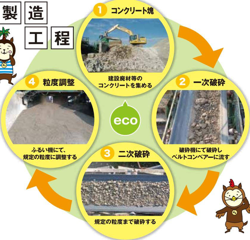
建設現場等から排出される建設廃材のコンクリート塊を細かく破碎し製造します。安心安全な製品です。
