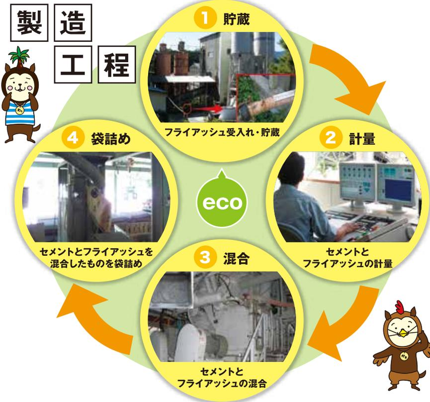
宮崎県内の石炭火力発電所から産出される灰（フライアッシュ）をセメントに加え、プレミックスした状態で出荷します。本製品を使用することで、強度・耐久性・施工性の改善に加えて、吹付け時の跳ね返りによる廃棄モルタルの低減が実現可能になりました。また、本工法に使用する骨材は、従来の海砂、山砂、砕砂に加えて、新燃岳などから噴出した火山灰も利用できます。
