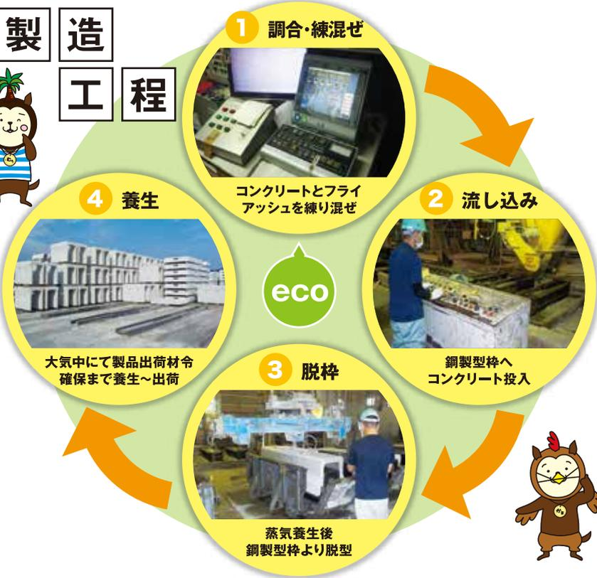
石炭を使用し発電している火力発電所より排出される灰（フライアッシュ）をコンクリートに混ぜ入れプレキャスト製品化しているリサイクル商品です。宮崎県内の公共工事ではもとより、多種民間工事等に使用される製品（側溝・擁壁・積ブロック等）として製造しています。今後もフライアッシュ排出量は減量する事が無いと思われまますので、製品への含有率に対して更に検討出来るリサイクル製品です。
