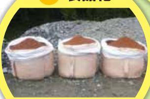
破碎された瓦チップは自動フルイ機により粒度調整し、搬出され製品化
