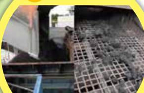
小割して破碎機にかけ、 粒度を調整する
