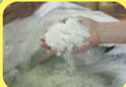
粉碎、洗浄、再加熱して3層に 張り合わせた原料 シートを作る
