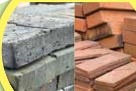
窯出しし、規格を外れているもの、色が暴れているものの選別
