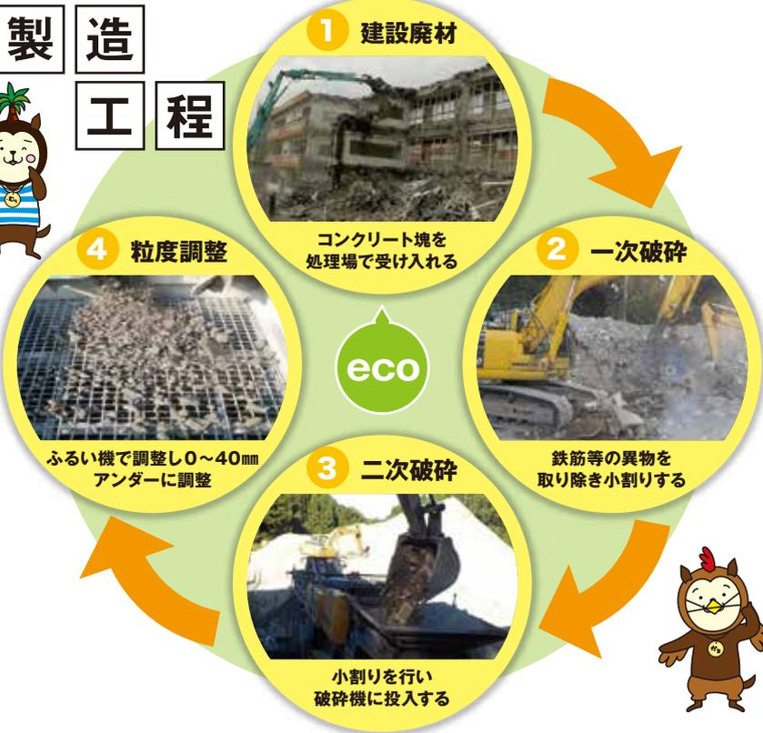
解体工事・土木工事現場などから搬出されたコンクリートやアスファルトコンクリートを破砕し、粒度調整したリサイクル製品です。
