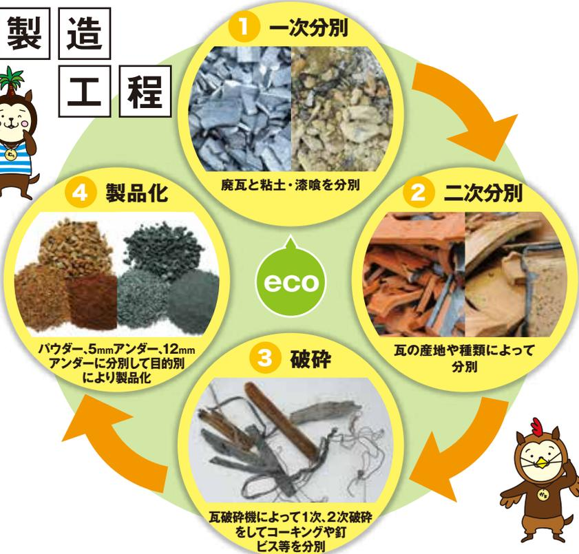
宮崎テコラは廃瓦や新築現場から出る瓦の廃材を小さく破碎して、表面の角を取り瓦の多孔質な性質を利用したリサイクル製品です。
