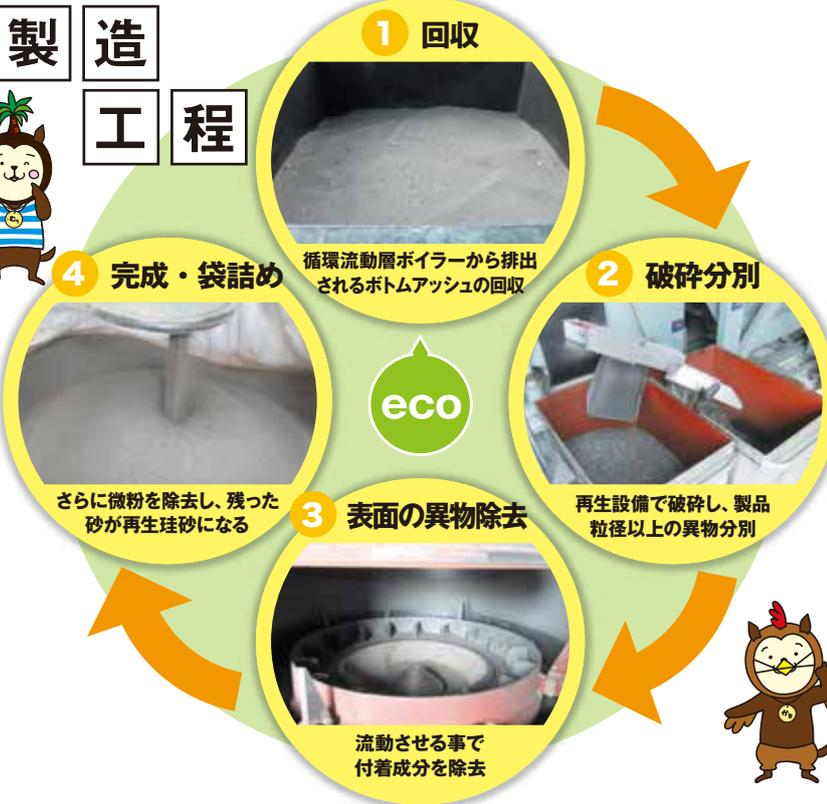
「再生珪砂」は、流動層式木質バイオマス発電所から排出される灰(ボトムアッシュ)を再生設備で異物や付着物を除去し、利用可能にしたリサイクル製品です。ボトムアッシュの素になる「川砂」は限りある天然資源です。流動層式木質バイオマス発電所に不可欠な材料であり、「再生珪砂」を使用することで「川砂」の使用量を軽減できます。また、「路盤材や水道管の保護材」として使用されている「山砂」や「川砂」の代替として「再生珪砂」を利用できます。「再生珪砂」は希少化する「川砂」の持続的利用に貢献している製品です。
