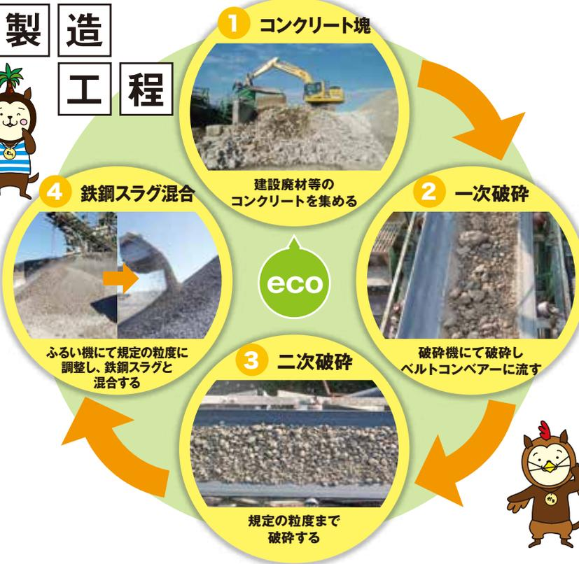
建設現場等から排出される建設廃材のコンクリート塊を細かく破碎し製造する、安心安全な製品です。建設リサイクル法により、コンクリートやアスファルトはリサイクルが義務付けられています。そこでコンクリート塊を30mm以下の大きさに破碎し、粒度を調整する処理を施し、グリーン購入法の指定品目である鉄鋼スラグ(水硬性粒度調整スラグ)と混合します。自然環境負荷の少ないエコな製品として、天然碎石の代替品として、ご利用いただいております。
