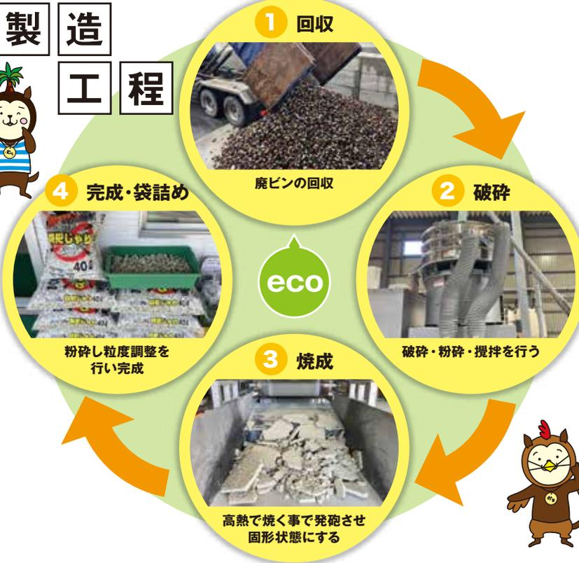
廃ガラスを粉砕、焼成発泡させることで生まれた人工の多孔質軽量発泡資材スーパーソルは、地球にやさしい土壌還元型資材であり、透水性・保水性に優れ、耐火性を兼ね備えております。
