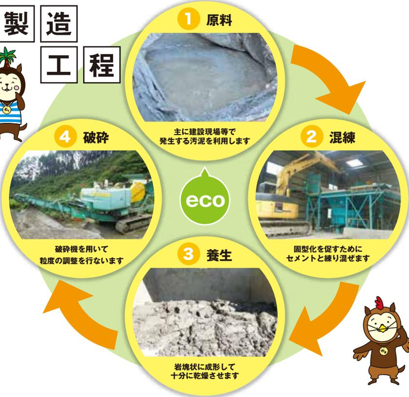
無機性汚泥はリサイクル製品として再び社会へ還元されます。従来、建設工事現場等で発生する無機性の汚泥は、ただ埋立処分場へ搬入されるだけの存在でした。弊社では、それらの廃棄物とセメント系固化材を混ぜ合わせるにより、再び工事現場等で有効活用できる土木用資材を製造しております。固型化を行なうことで、再泥化並びに有害成分の溶出も防止しております。再生された当製品は、盛土や埋戻し土、路盤材、地盤改良材など、幅広く利用できます。
