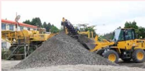
解体工事、土木建設現場等から発生する産業廃棄物のコンクリートとアスファルトコンクリートを破砕し粒度調整したリサイクル材で、循環資源割合は100% (コンクリート塊70%+アスファルトコンクリート塊30%) です。弊社のRC-40 (粒度0~40) は道路の下層路盤材や構造物の基礎材として、これまで多くの民間・公共工事に使用され、徹底した品質管理体制の基、高品質で信頼性の高い製品の供給に努めています。
