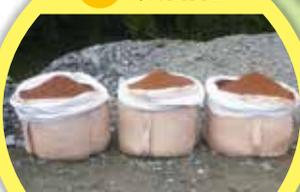
破碎された瓦チップは自動ふるい機により粒度調整し、搬出され製品化
