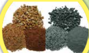
パウダー、5mmアンダー、12mm アンダーに分別して目的別 により製品化
