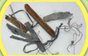
瓦破碎機によって1次、2次破碎 をしてコーキングや釘 ビス等を分別
